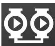
Fig. 49 Circulateurs simples connectés en parallèle.
